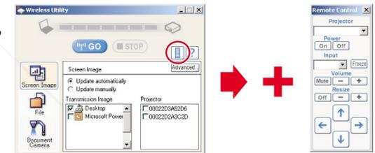
Es ist möglich diese Funktion nur zum Bedienen des Projektors zu verwenden. Wird die Software **Wireless Utility** jedoch beendet, so wird auch das Fenster **Remote Control** geschlossen.
