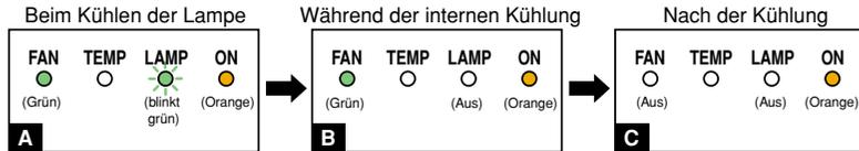
**A** Während der Kühlung blinkt die LAMP-Anzeige. In dieser Phase kann das Gerät nicht wieder eingeschaltet werden. Darüber hinaus hat das Abziehen des Netzsteckers eine Verkürzung der Lebensdauer der Lampe zur Folge.
