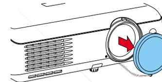
Stellen Sie vor dem Einschalten sicher, dass die Objektivkappe entfernt wurde. Ist dies nicht der Fall, kann sich die Kappe aufgrund der Hitze verformen.
