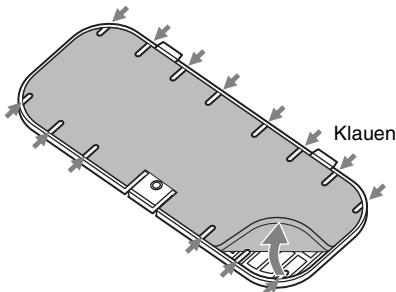
5 Waschen Sie den Luftfilter mit einer milden Reinigungslösung, und lassen Sie ihn an einem schattigen Ort trocknen.
