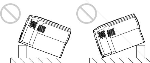
N'installez pas l'appareil à d'autres endroits qu'au sol. Ne réglez pas la hauteur du projecteur autrement qu'en agissant sur le dispositif de réglage. Ne faites pas fonctionner pas le projecteur s'il est incliné vers le haut ou vers le bas. De telles installations peuvent être à l'origine de dysfonctionnements.
