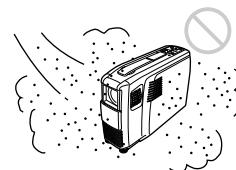
Evite instalar la unidad en un lugar donde haya mucho polvo. En caso contrario, el filtro de aire se obstruirá. Si el polvo bloquea el paso de aire a través del filtro, el calentamiento interno del proyector puede aumentar. Límpielo periódicamente.
