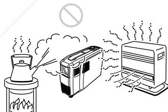
N'installez pas l'appareil dans un endroit où la température et l'humidité sont très élevées ou dans un endroit très froid.
