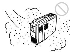
N'installez pas l'appareil dans un endroit très poussiéreux, faute de quoi le filtre à air va s'obstruer. La poussière obstruant le passage de l'air dans le filtre peut entraîner une augmentation de la température intérieure du projecteur. Nettoyez-le régulièrement.
