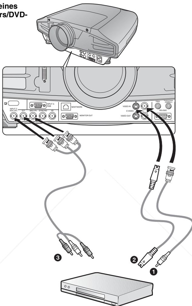
Bei Videosignalverbindungen haben Sie die folgenden drei Anschlussmöglichkeiten:
