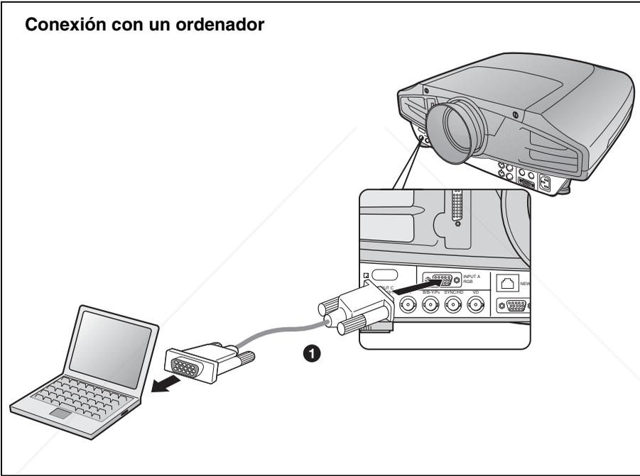
Para realizar conexiones de señales de vídeo, puede utilizar las dos opciones de conexión
