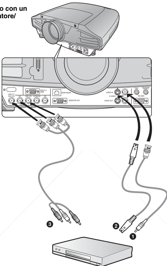
Per quanto riguarda i collegamenti di segnali video, sono possibili i tre tipi di connessioni che seguono:
