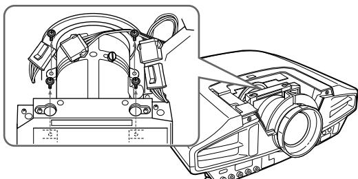
**7** 轻轻抬起透镜，拉长透镜衬垫并向前推动取出透镜。
