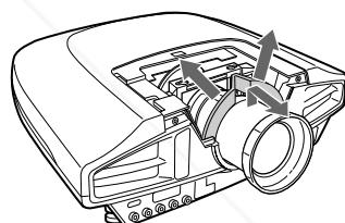
**8 レンズクッションを引き伸ばしながらレンズを通し、交換するレンズ側とプロジェクター側のストッパーで位置を合わせてレンズを組み込む。**
