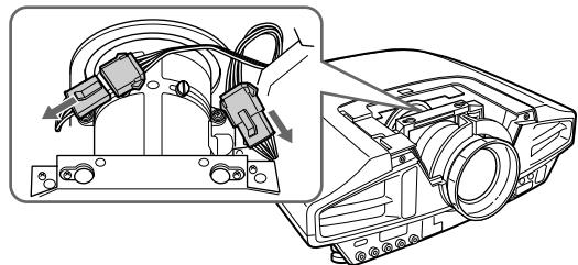
**6 レンズを固定している4本(M4×12, ワッシャー付)のネジをプラスドライバーではずす。**
