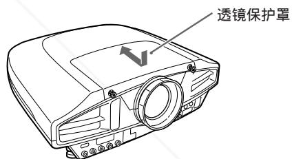
**13** 拧紧两颗螺钉，牢牢固定透镜保护罩。
