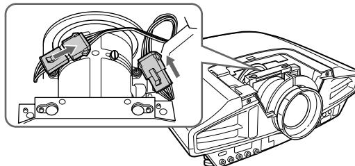
**11** 将在步骤 4 中松开的连接器电缆用电缆扣带固定。
