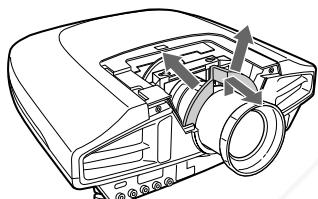
**8** 拉长透镜衬垫并安装透镜，使透镜挡块的边缘与投影机挡块的边缘相接触。
