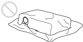
Ne recouvrez pas les orifices de ventilation du projecteur (prise/sortie d'air) pour éviter une surchauffe interne.
