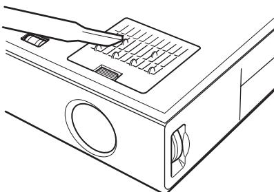
Si resulta difícil retirar el polvo del filtro con un aspirador, desmonte el filtro de aire y lávelo.
