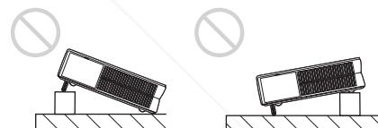
Évitez d'utiliser cet appareil lorsqu'il est incliné en dehors des limites du support réglable. Une telle installation pourrait provoquer des taches de couleurs ou raccourcir excessivement la durée de service de la lampe.
