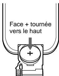
**3** Remettez le porte-pile au lithium en place dans la télécommande.
