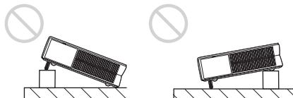
Evite utilizar la unidad con una inclinación que se encuentre fuera del margen de regulación del ajustador. Una instalación así puede provocar sombras de color o acortar excesivamente la vida de la lámpara.
