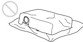
Evite emplear algo que cubra los orificios de ventilación (escape/aspiración); en caso contrario, es posible que se produzca un recalentamiento interno.
