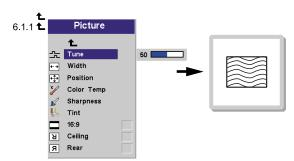
Adjusts horizontal phase/fine tunes computer analog image Einstellung der Horizontalfrequenz/Feinabfeich für analoge Computerbilder Règle la phase horizontale/met au point l'image analogique de l'ordinateur Ajusta la fase horizontal/sintoniza la imagen del ordenador analógico Regolazione della fasatura orizzontale/sintonizzazione fine dell'immagine analogica del computer
